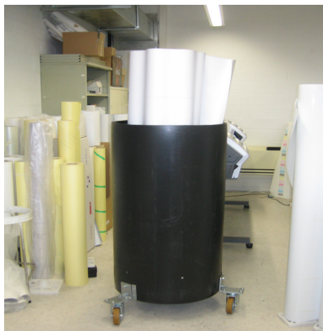
Rys.2 Tuba z wentylatorem do szybkiego suszenia.
